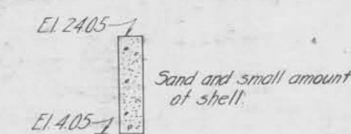
CORE DRILL SECTION Sta 479+2
